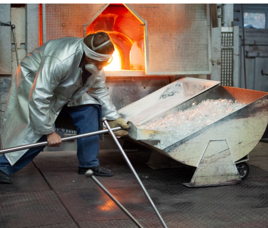
TAVENÍ SKLA V PECI, SKLÁŘSKÁ PEC, NAKLÁDÁNÍ STŘEPŮ A SKLÁŘSKÉHO KMENE DO PECE, POHLED NA PRACOVNÍ OTVOR PECE
