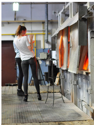
TAVENÍ SKLA V PECI, SKLÁŘSKÁ PEC, NAKLÁDÁNÍ STŘEPŮ A SKLÁŘSKÉHO KMENE DO PECE, POHLED NA PRACOVNÍ OTVOR PECE
