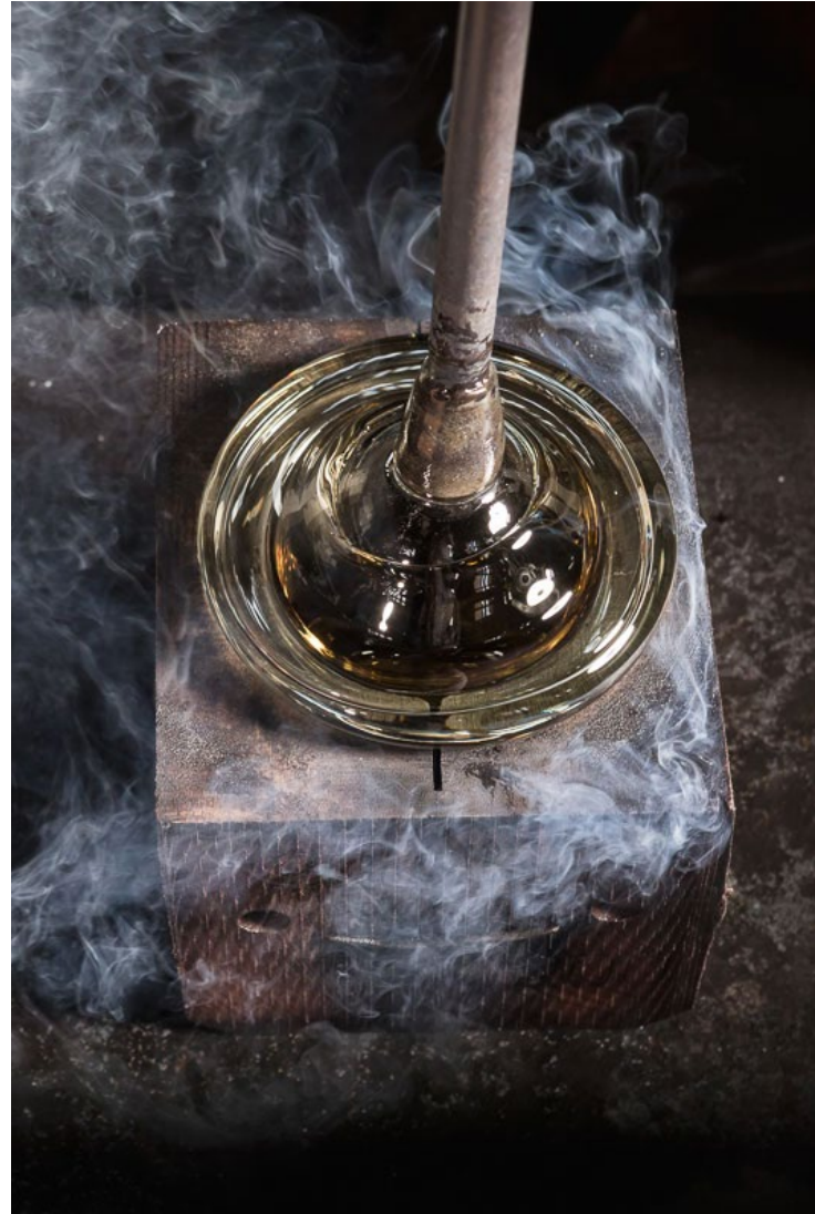
FOUKÁNÍ SKLA DO DŘEVĚNÉ FORMY (SKLÁRNA RÜCKL)
