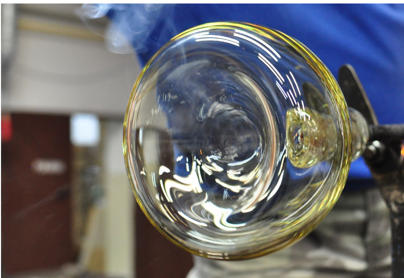
FORMOVÁNÍ SVALÁKEM, TVAROVÁNÍ BAŇKY POMOCÍ DŘEVĚNÉHO A KOVOVÉHO KOLÍKU
