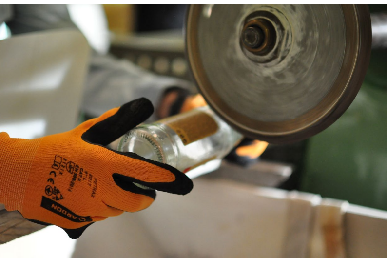
BROUŠENÍ A SÁMOVÁNÍ HRAN NA DIAMANTOVÉM KOTOUČI
