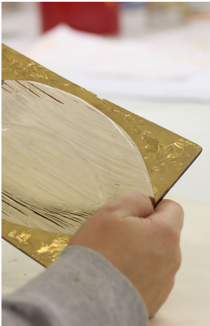
VLEVO: TŘENÍ SKLÁŘSKÉ BARVY TŘÍČEM NA PALETĚ, VPRAVO: VZORKY MALOVANÉHO SKLA
