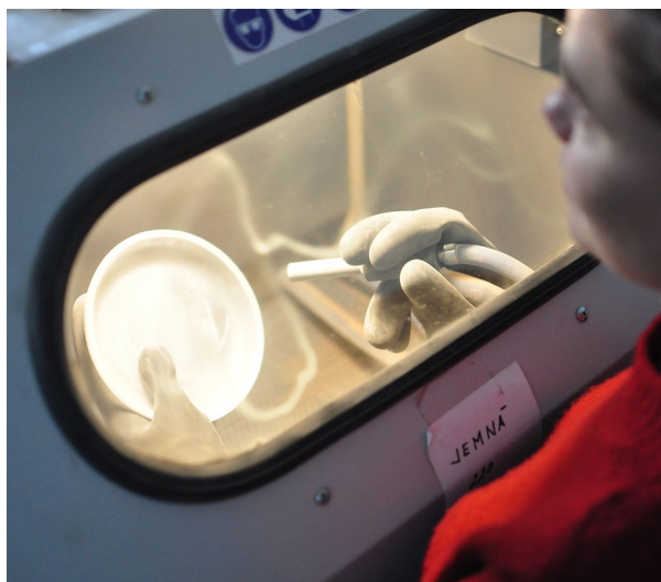
BOX NA PÍSKOVÁNÍ SKLA (PÍSKOVAČKA), PROCES PÍSKOVÁNÍ
