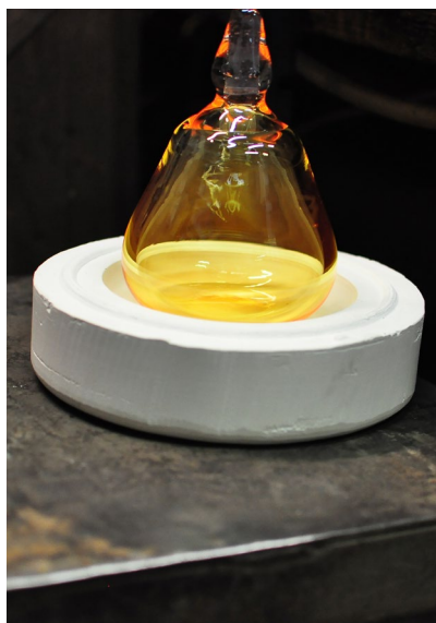
VÝKLAD A KONZULTACE NÁVRHŮ, FOUKÁNÍ SKLA DO SÁDROVÉ ROTAČNÍ FORMY
