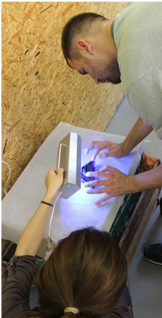
LEPENÍ UV LEPIDLEM ZA POMOCI UV LAMPY
