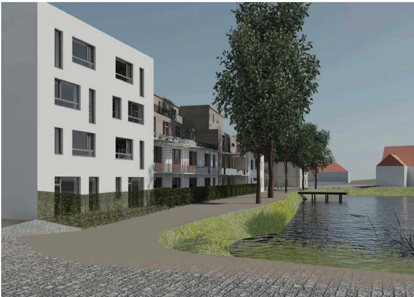
Pohled na bytový dům směrem k pivovaru. Předzahrádky dodržují minimální hloubku 3m od veřejné komunikace, protože jsou zde v přízemí byty.
