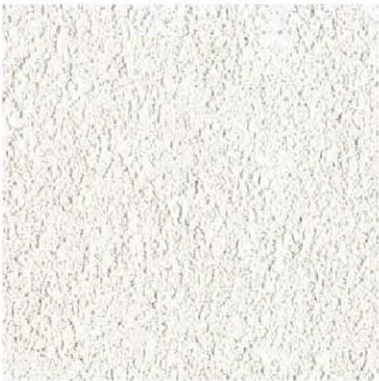
NEJVICE POUŽITÝM FASÁDNÍM MATERIÁLEM BUDE STĚRKOVÁ BÍLE PROBARVENÁ OMÍTKOVINA, KTERÁ JE NAVRŽENA NA JEDNOM Z VILADOMŮ I NA PODLAŽÍ NA ÚROVNI ROKLE.
