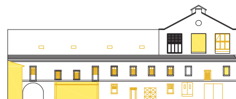
současný stav, vyznačeny odstraňovaná konstrukce
