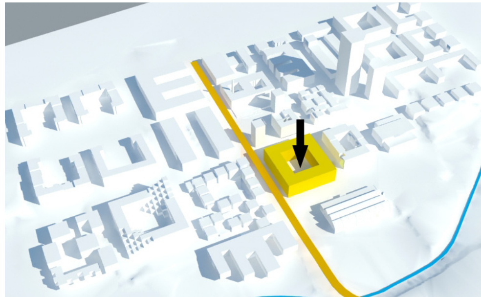
vytvoření vnitrobloku - hloubka jednotlivých částí je dimenzována tak, aby budoucí provozové měly dostatek osvětlení a oslunění
