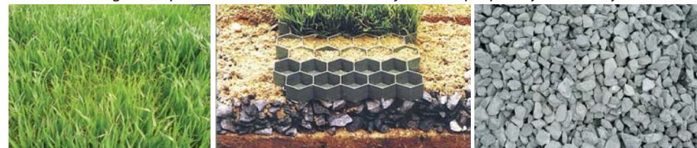
příklady propustných materiálů (tráva, zatravnovací dlaždice, štěrk), které se dají používat náhradou za nepropustné, především asfalt.
