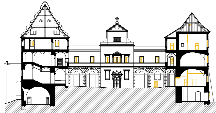
POHLED ZÁPADNÍ - NÁDVOŘÍ rušené konstrukce
