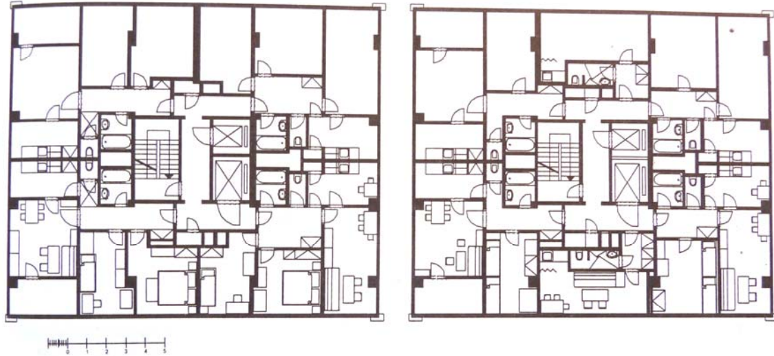
Bodový bytový dům (věžový), typické podlaží; v podlaží 9. až 21. byty pouze I., II. a III. Velikostní kategorie. Slezák, Vrána.
