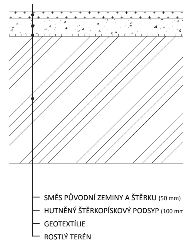
HUTNĚNÁ ZEMINA SE ŠTĚRKEM
