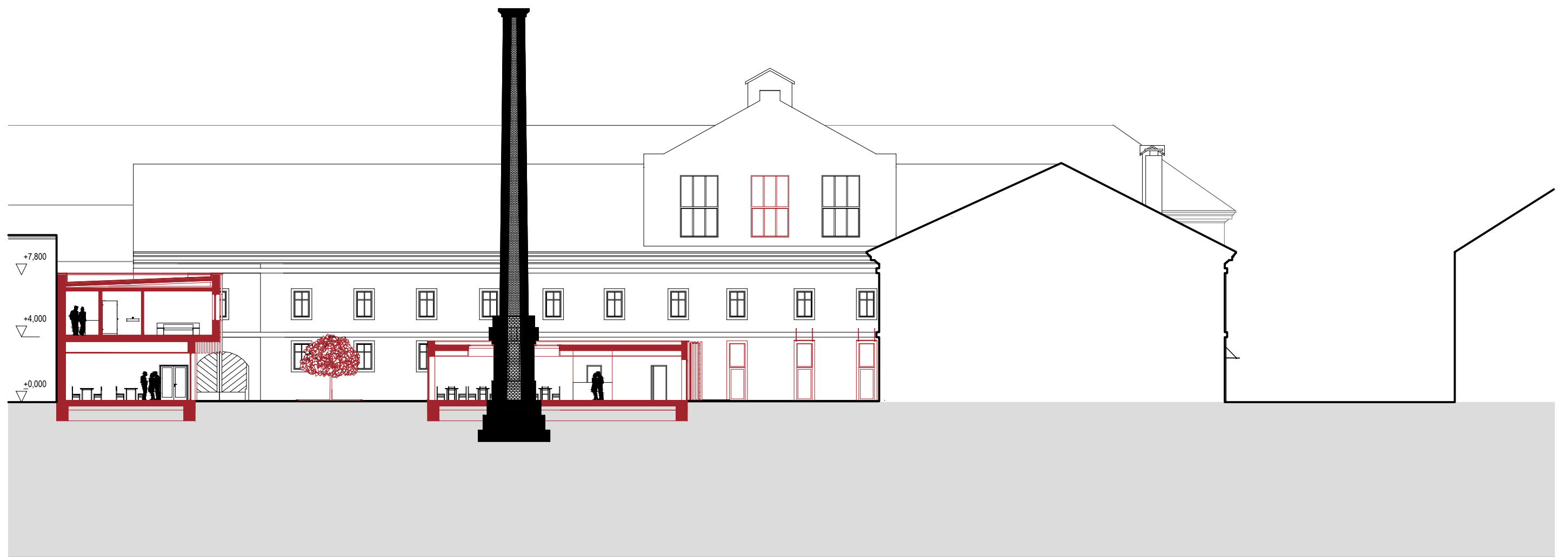
ŘEZ PODÉLNÝ NOVOSTAVBOU UBYTOVÁNÍ KAVÁRNY M 1:250
