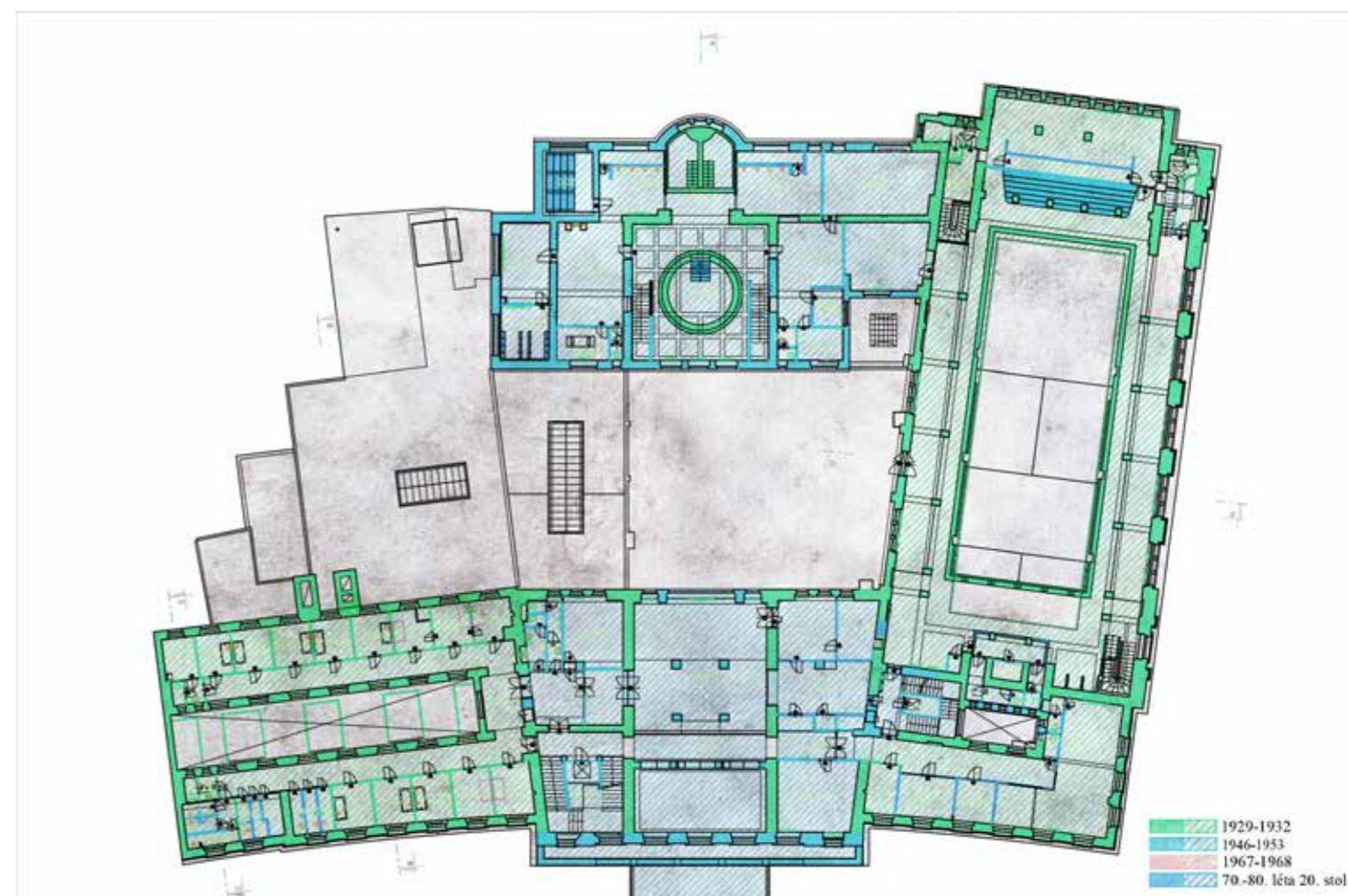
DATECE JEDNOTLIVÝCH KONSTRUKCÍ 2.NP
