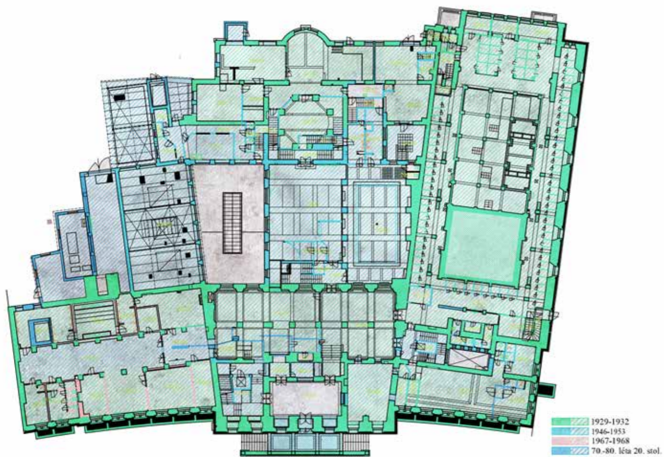
DATECE JEDNOTLIVÝCH KONSTRUKCÍ 1.NP
