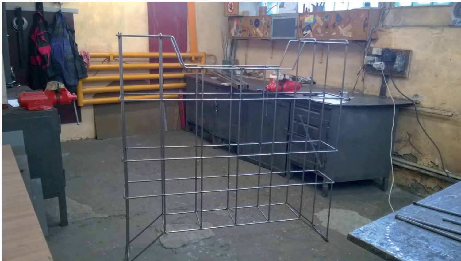
Hotová konstrukce před práškové lakování kovů komaxitem
