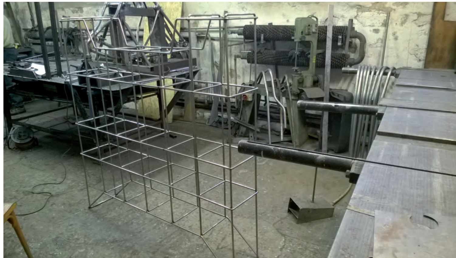
Hotová konstrukce před práškovým lakováním komaxitem
