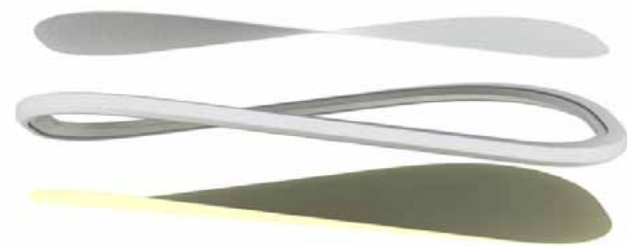
vrchní díl – ocelový plech
