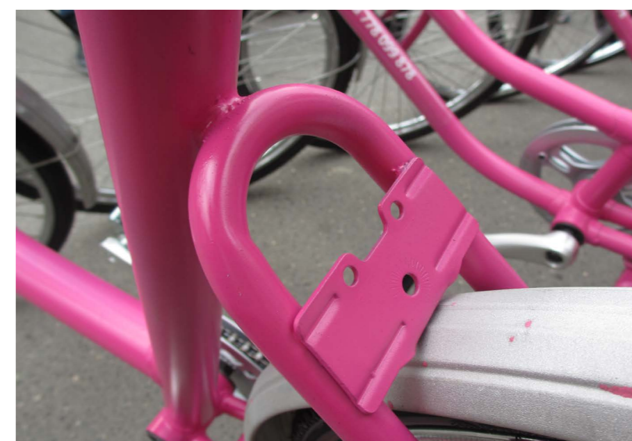
Ukázka destičky, ke které se přidělavá tělo zámku [5]
