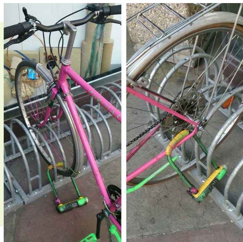
Ukázka zamčeného kola - špatně (vlevo), správně (vpravo) [1]
