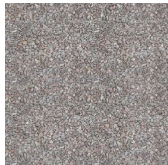
MZK minerálně zpevněné kamenivo - pro parkování - měkký materiál s dobrou propustností - bezbariérová úprava
