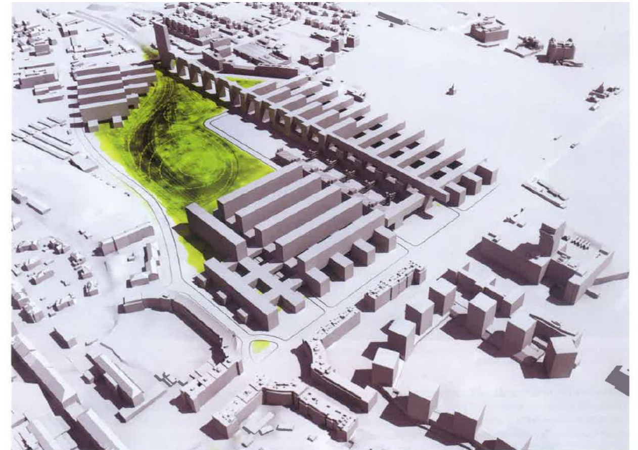
4c Jonáš Krýzl, Kateřina Kulanová, Dušan Štefanič (Ateliér Ivana Kroupy Architektura II na VŠUP v Praze): Nákladové nádraží Žižkov – Mřížka; zhuštění zástavby umožňuje uvolnění prostoru pro zachování cenného přírodního prostředí; vzniká vertikálně a horizontálně členěná kompoziční struktura, otevřená pro změny v čase; pojivo – neměnná mřížka jader / plnivo – přizpůsobující se hmoty, výplně mezi jádry; variabilita funkcí – pobídka k vytvoření soběstačné čtvrti; zdroj: AII VŠUP.
