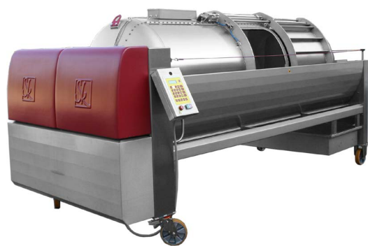
pneumatický lis orientační rozměry: objem 16hl - 3,5x1,2x1,6m objem 55hl - 5,5x1,8x2,4m objem 150hl - 6,5x2,5x2,7m
