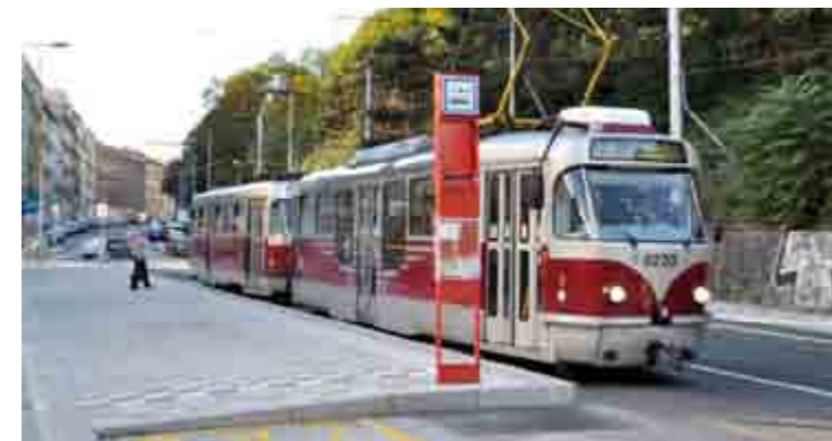
bezbariérová tramvajová zastávka
