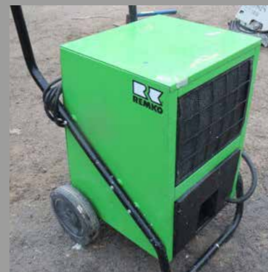
▼ Deformace ochranné mřížky
