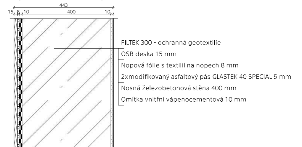
S03 NOSNÁ STĚNA V 1.PP pod základovou deskou přízemí
