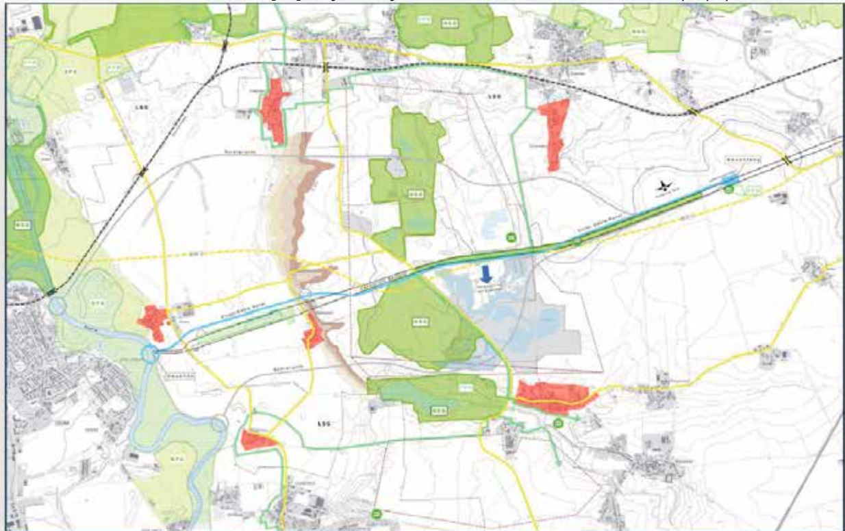
Abbildung 31 Restriktionen/ Vorkanaltrasse Quelle: ICL
