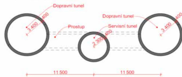
Řez dvouprúdovým tunelem
