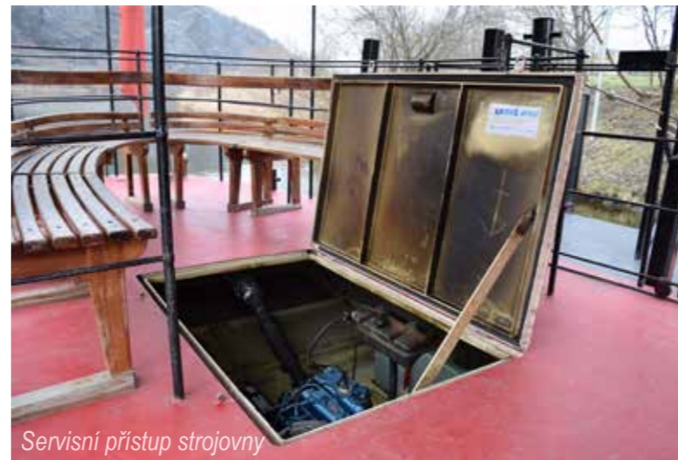
Servisní přístup kormidlovacího zařízení
