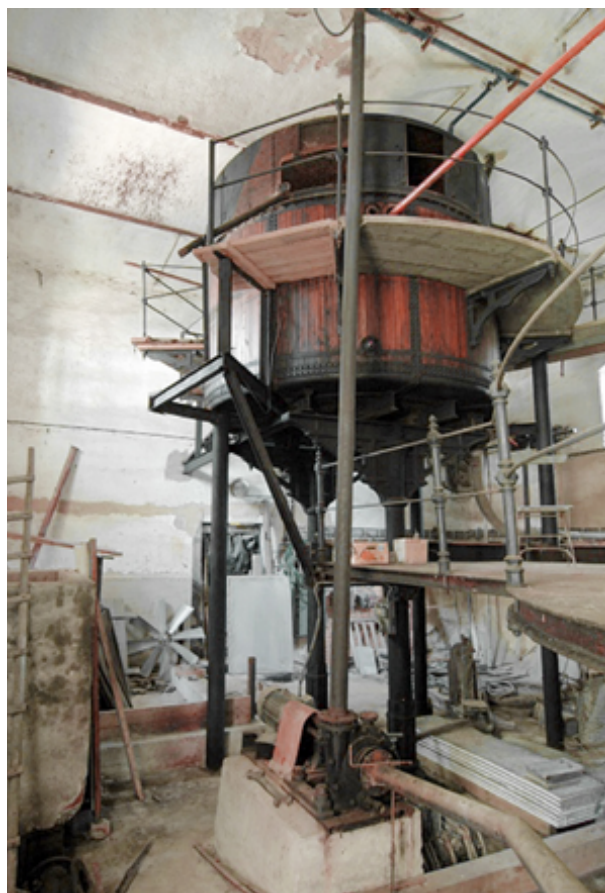
Parostrojní pivovar a sladovna v Milíně, výjimečně zachovaná technologie pivovaru, ačkoliv je v dnešní době nefunkční, majitelé jsou nakloněni rekonstrukci. 22
