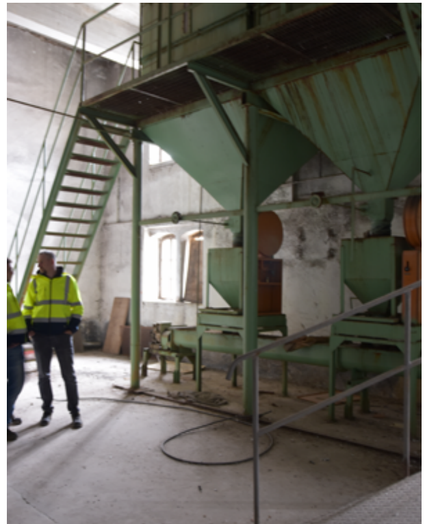
šrotovník sladu v převýšené místnosti v 5NP
