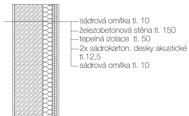
S3 Stěna mezi třídou a chodbou
