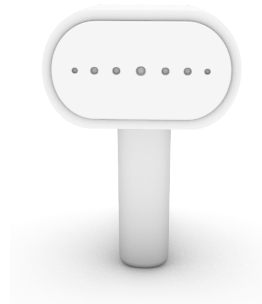
č. 27 a 28: Některé z dalších vyzkoušených variant panelu páry; zjištěno, že lépe působí lichý počet otvorů trysek, jedna tryska pak ve středu panelu. Testování různých průměrů a velikostí rozdílů mezi nimi.
