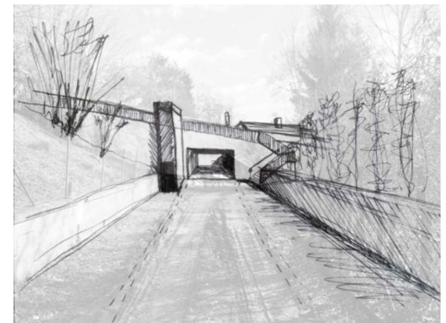
Těleso silnice 240 v údolní nivě. Viadukt je nepatrně rozšířen tak, aby mohl být zřízen průběžný chodník. Dílo bude řešeno jako novostavba se zachováním historických kvalit.
