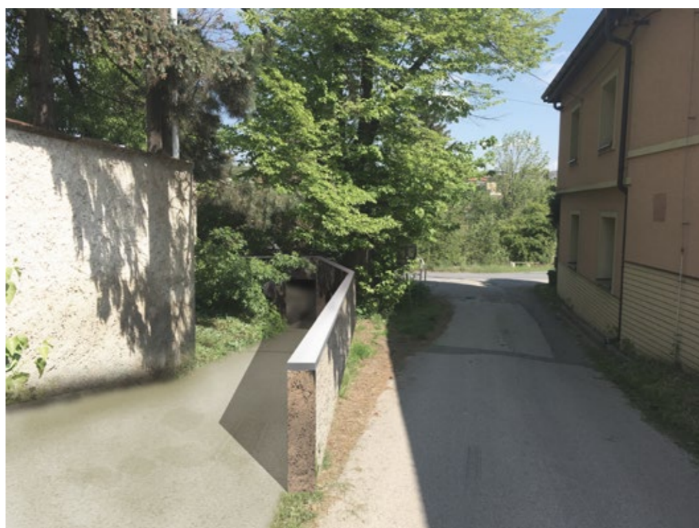
Větší zásah potřebný pro realizaci záměru bude zklesat cestu až na dno odvodňovacího prostupu.
