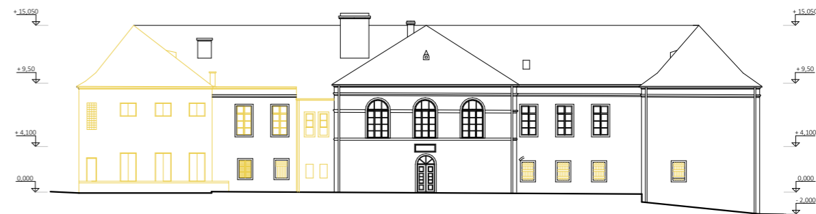
Pohled severní- demolice
