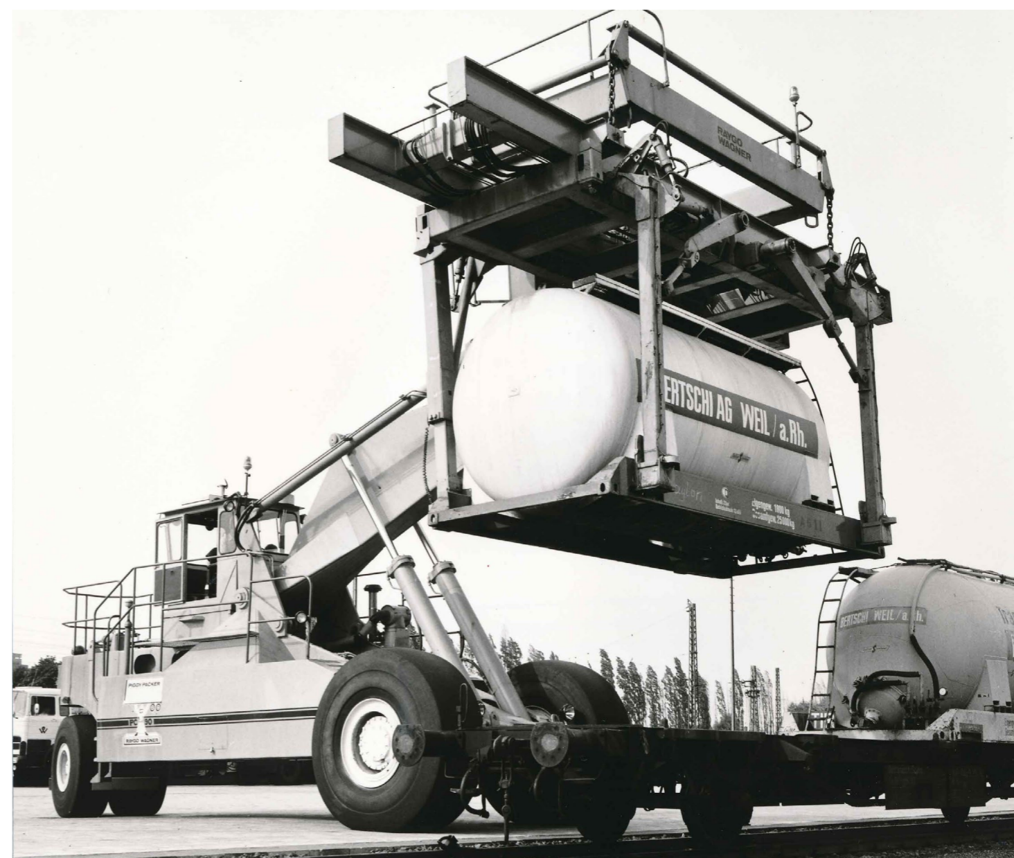
Kontejnerový manipulátor „Piggy Packer“ [6]
