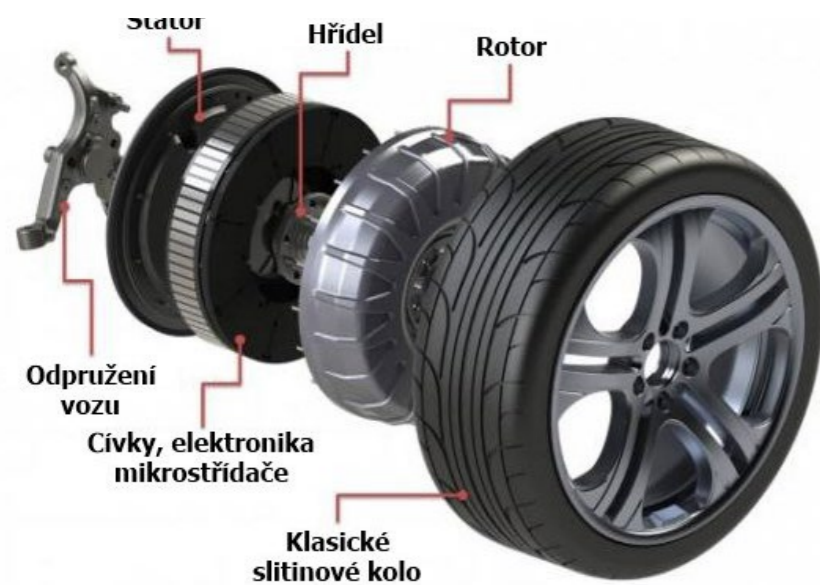
Schéma uspořádání elektromotoru v kole [34]
