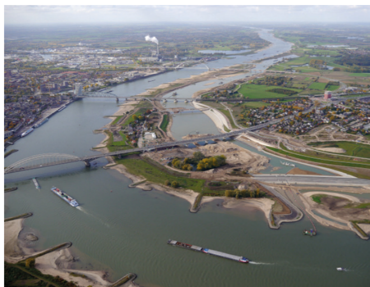
Obr. 4 Holandské město Nijmegen na řece Waal, kde došlo k přemístění hráze, vytvoření nového koryta řeky a ostrova (Climate-ADAPT 2016)
