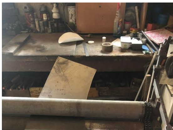
Obrázek 57: Ohýbání plechu, vlastní tvorba
