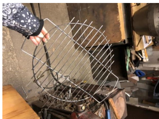
Obrázek 51, 52, 53, 54: Výroba modelu roštu, vlastní tvorba
