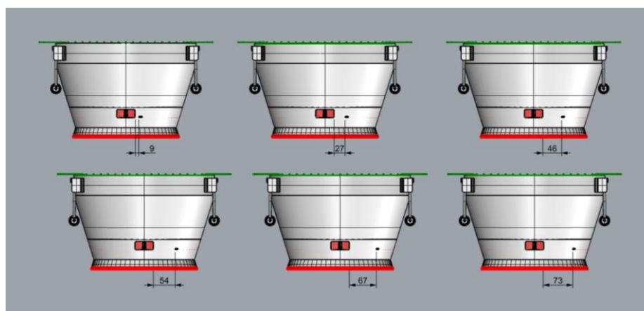
Obrázek 81: Vzdálenost umístění USB-C, vlastní tvorba
