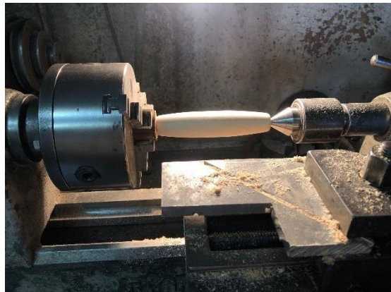
Obrázek 59, 60: Soustružení madla, vlastní tvorba
