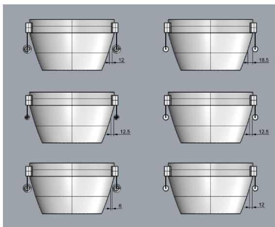
Obrázek 44: Vzdálenost mezi hlavním tvarem a madlem, vlastní tvorba
