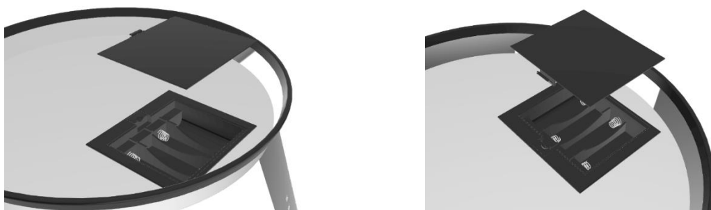
Obrázek 82, 83: Otvor pro čtyři AA baterie, vlastní tvorba
