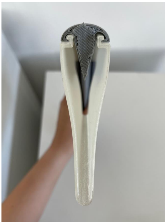
Obr. 16: Průřez zkušebního 3D tisku svítidla
