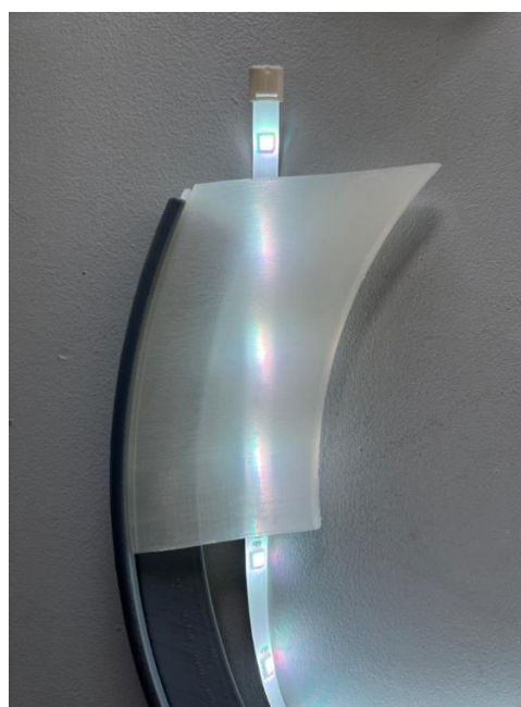
Obr. 19: Zkouška průsvitnosti difuzoru 2
