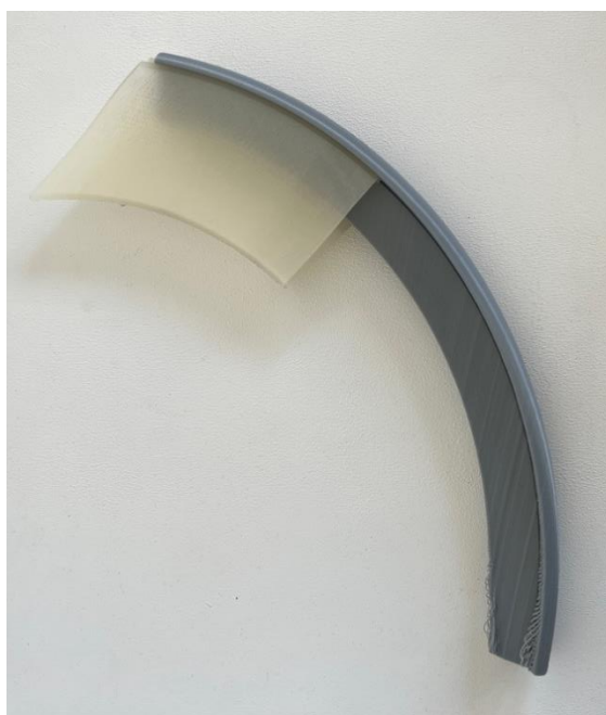
Obr. 17: Zkušební 3D tisk výseče svítidla
