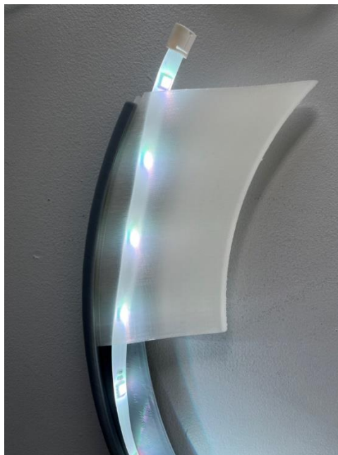
Obr. 18: Zkouška průsvitnosti difuzoru 1
