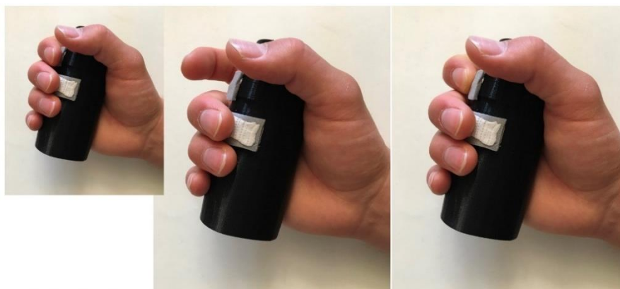
Obr 28: Obr. Hmotový model – ověření ergonomie pro větší dlaň (vlastní obrázek autorky)
