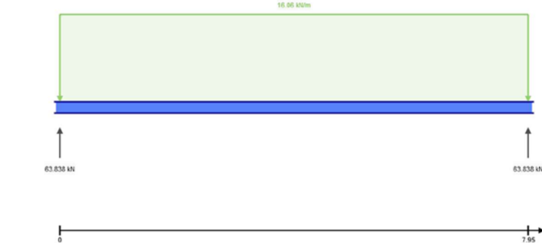
Obrázek: Schéma zatížení ve výpočtovém programu SkyCiv Beam
