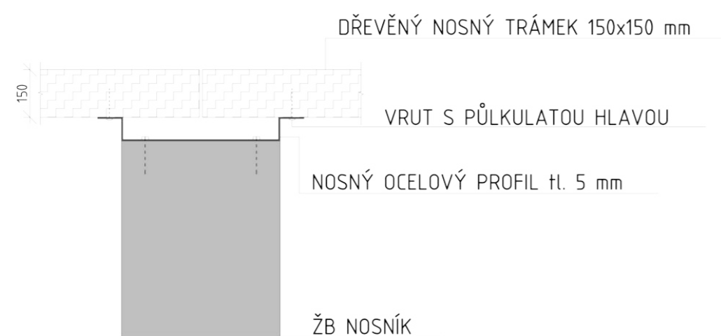
DETAIL NAPOJENÍ NOSNÝCH TRÁMKU NA ŽB NOSNÍK
