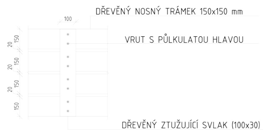
DETAIL SPOJENÍ TRÁMKŮ (SPODNÍ POHLED)
