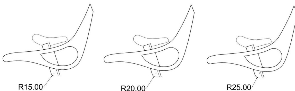
Obr. 43: Zaoblení rohu sedlovky. Foto autor
