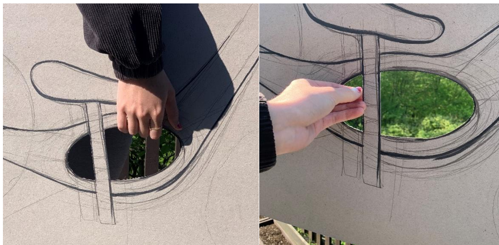
Obr. 34. Zkouška velikosti pro úchop. Foto autor Obr. 35. Zkouška zadního prostoru. Foto autor
