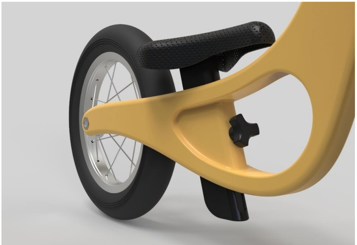
Obr. 59: Detail nastavení sedla. Render autor
