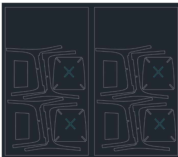
Obr. 41: AutoCAD pohled, deska s linkami pro řezání čtyř židlí
