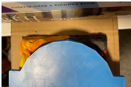
Obr. 81: Zkouška stabilního umístění mísy do těla hnětače (archiv autora)
