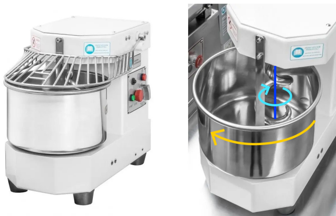
Obr. 02: Spirální hnětač a schéma jeho pohybu 5
