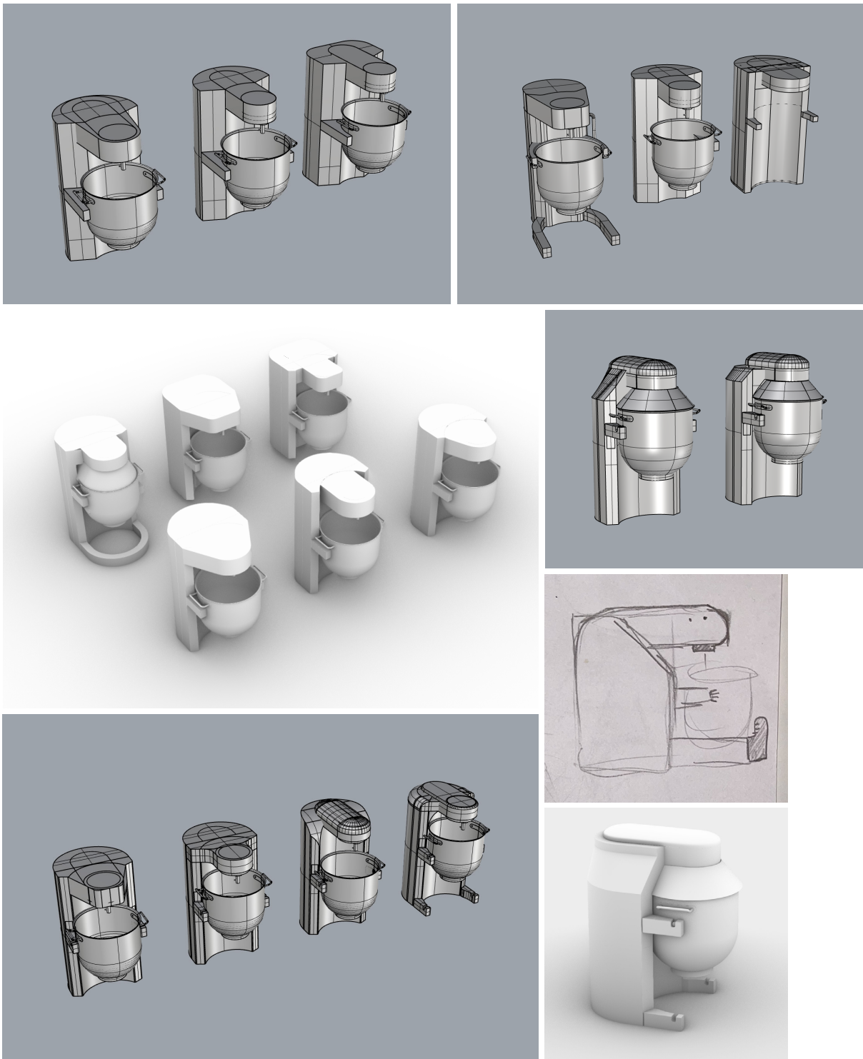
Obr. 55: Varianty napojení hlavy na finální tělo přístroje (archiv autora)
