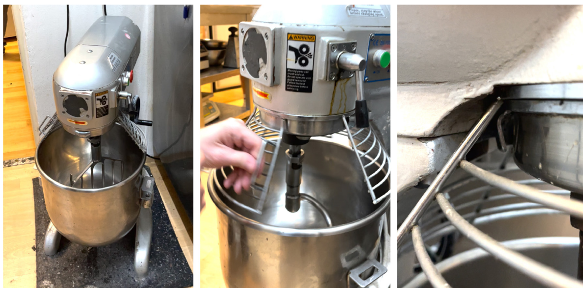
Obr. 13: Planetární hnětač 30 l – zavírání krytu a pojistka krytu (archiv autora, březen 2023)
