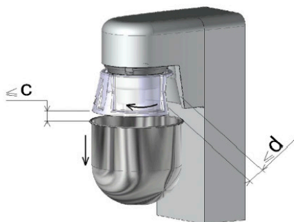
c) Ochranný kryt s blokováním s otáčivým pohybem ve spuštěné poloze
