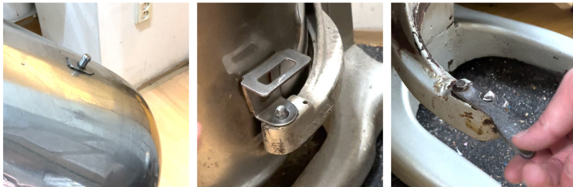
Obr. 14: Mísa a její upevnění k tělu hnětače (archiv autora, březen 2023)
