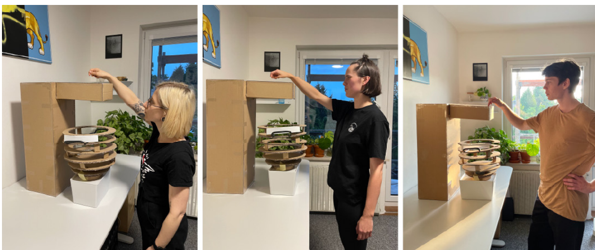
Obr. 69: Viditelnost a dosah tlačítka total stop (archiv autora)
