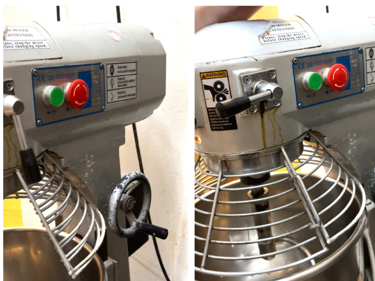
Obr. 15: Kolo na zvedání mísy a ovládací panel (archiv autora, březen 2023)
