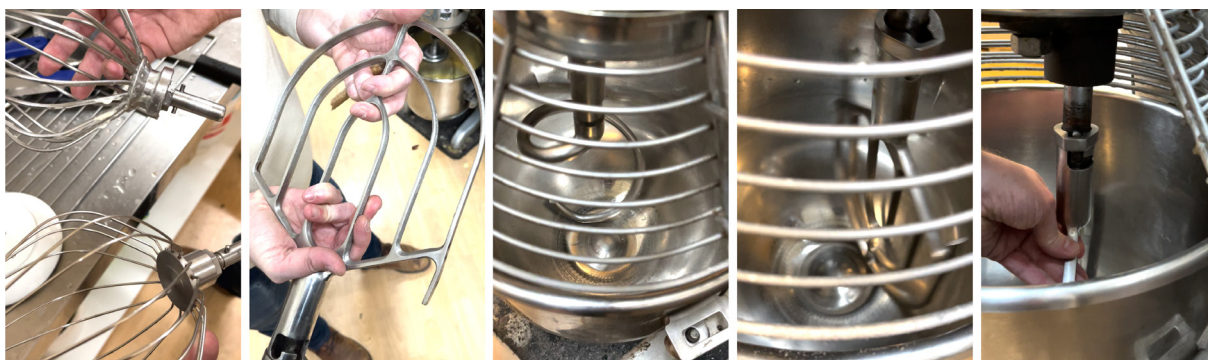
Obr. 17: Druhy míchadel a jejich nasazení (archiv autora, březen 2023)
