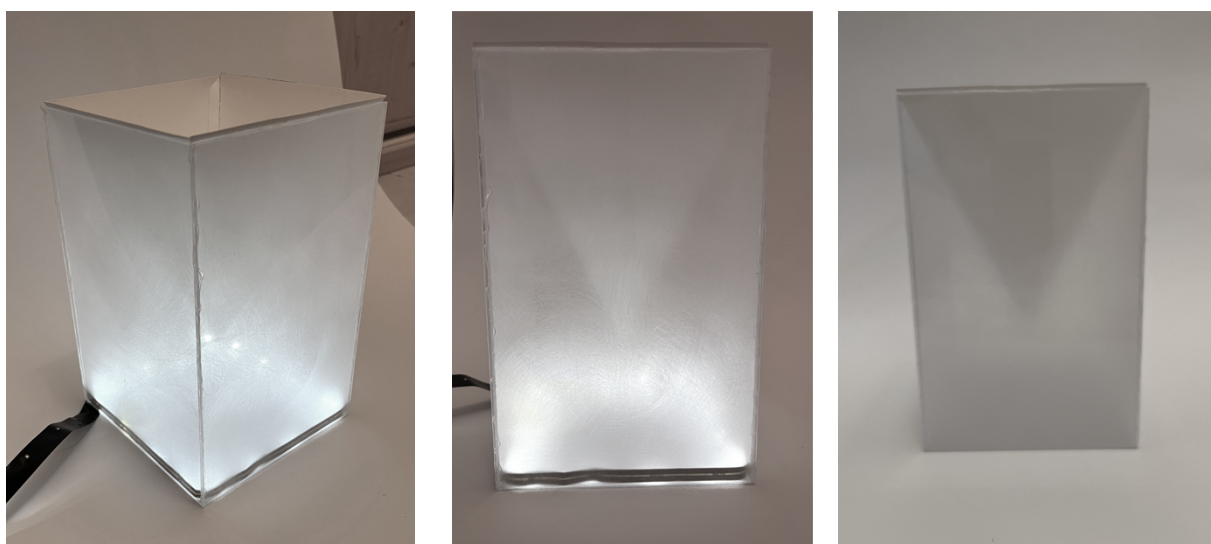
Obr. 88-90: Model č.4, měřítko 1:5, kryt z matného plexiskla (ruční povrchová úprava)
