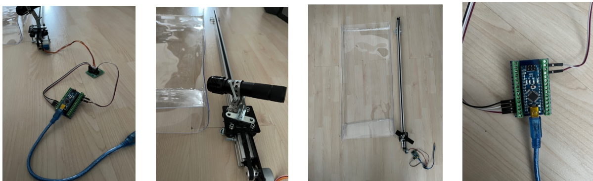
Obr. 40-43 : mechanismus s lineárním pohonem a zdrojem světla, řízen pomocí arduina.
