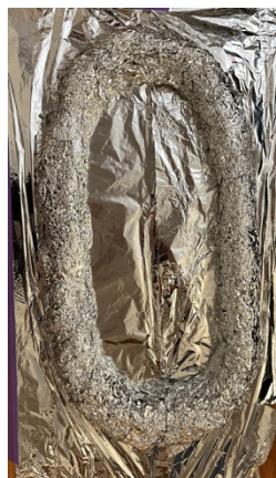
Obr. 44 a 45: improvizovaná forma a výsledná nádoba naplněná vodou
