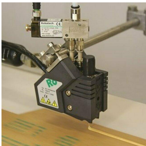
Obr. 04: Hot-melt, nanášení housenkou
