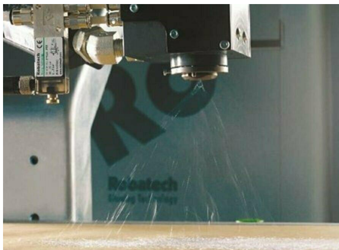
Obr. 05: Nanášení tavného lepidla sprejováním
