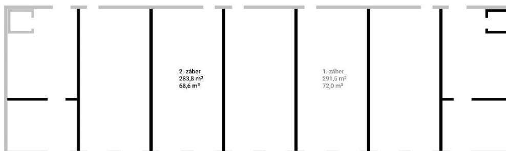
Schéma betonárskych záberov zvislých konštrukcií
