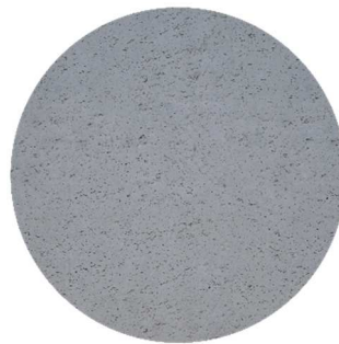
Hlazený pohledový beton
