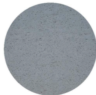
Hlazený pohledový beton
