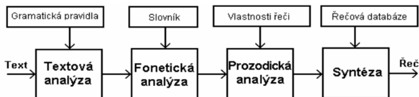
Obr. 5: Blokové schéma systému pro převod textu na řeč
