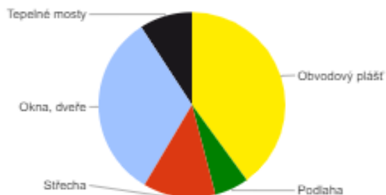
Tepelné ztráty jednotlivými konstrukcemi - po zateplení
