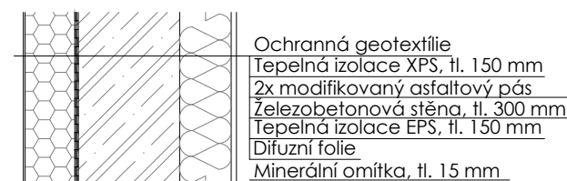
S6 - Exteriérová nosná stěna pod terénem
