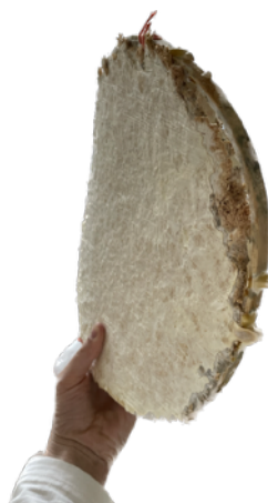
Obr. 27: Vysušený substrát vrostlý do bambusového rámu, který se při vysychání zkroutil
