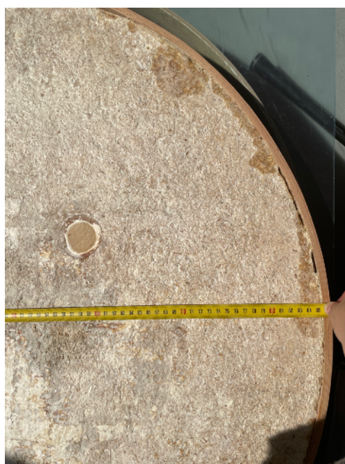
Obr. 11: Měření smrštění mycelia
