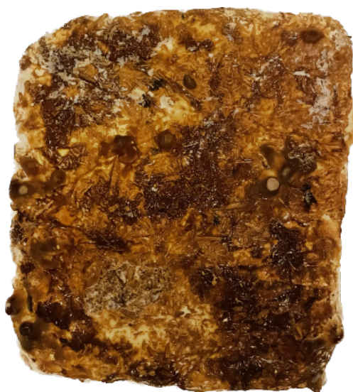
Obr. 06: Mycelium povrchově upravené lněným olejem
