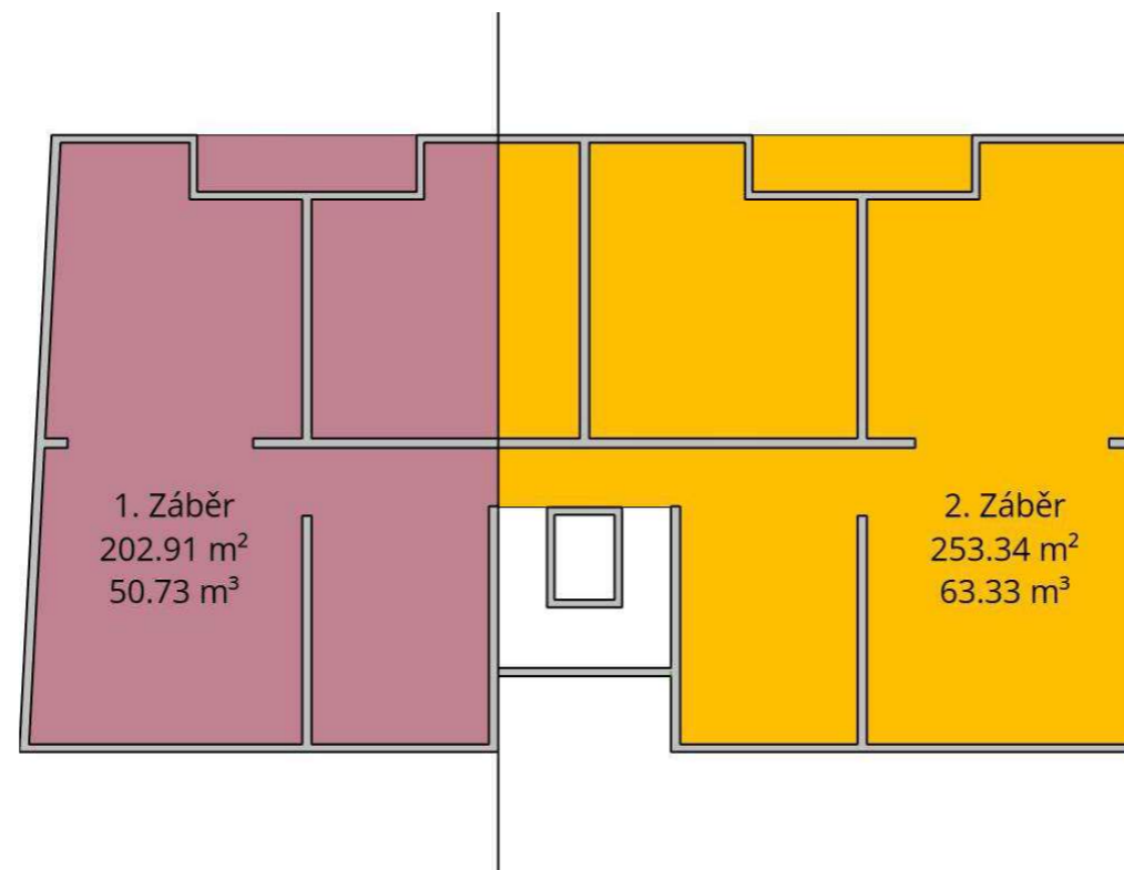
(Obr. 01: Výkres vodorovných záběrů)
