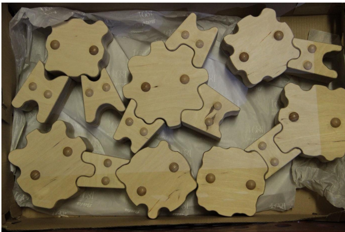
Obrázek 65: Stavebnice 1. varianta, hmatově rozlišena, před povrchovou úpravou
