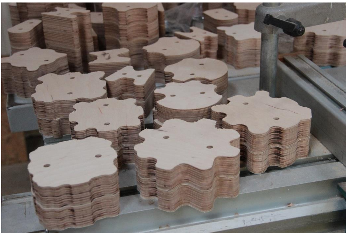
Obr. 62: Slepéné kusy stavebnice, materiál překližka
