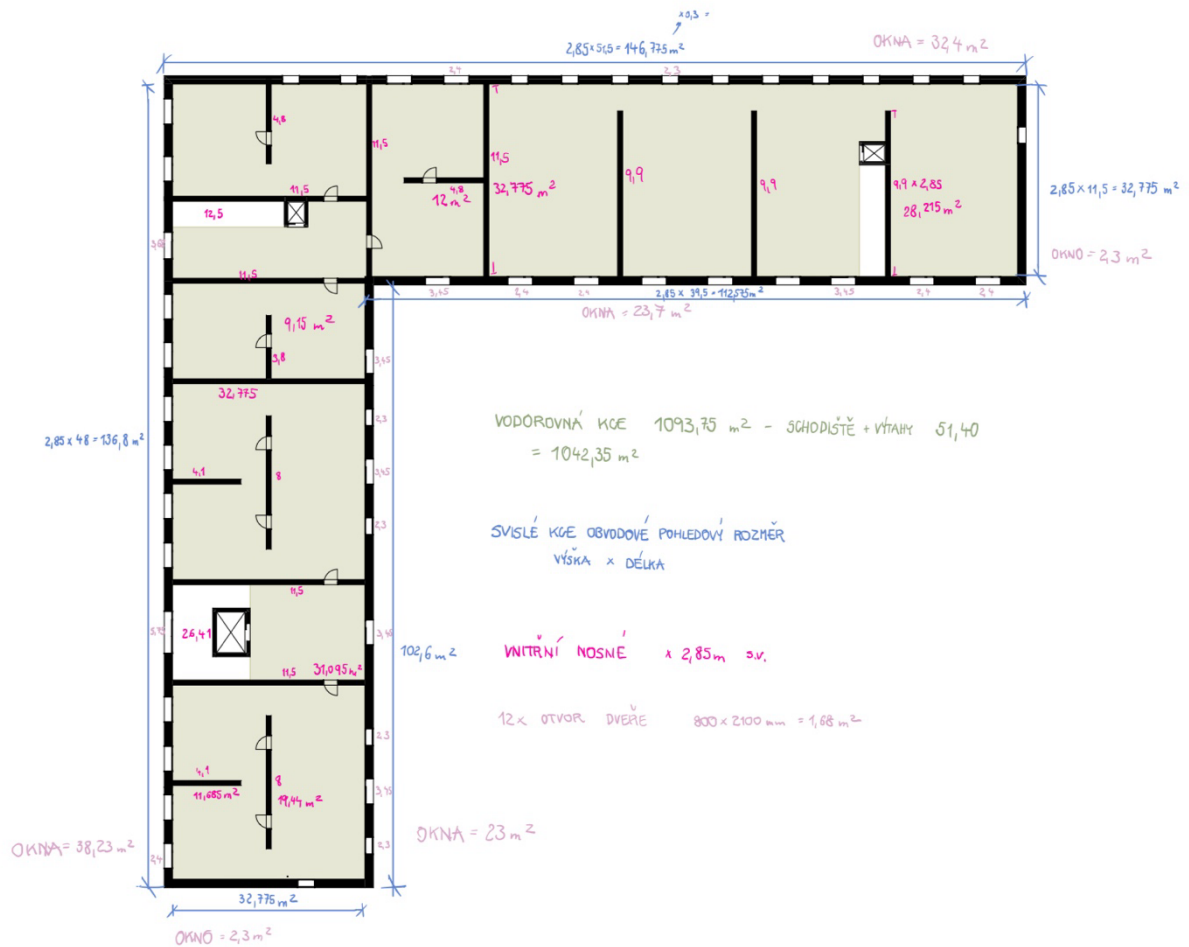
Obrázek č. 7 – Schéma svislých a vodorovných kcí k betonáři – zeleně vyznačeny vodorovné kce
