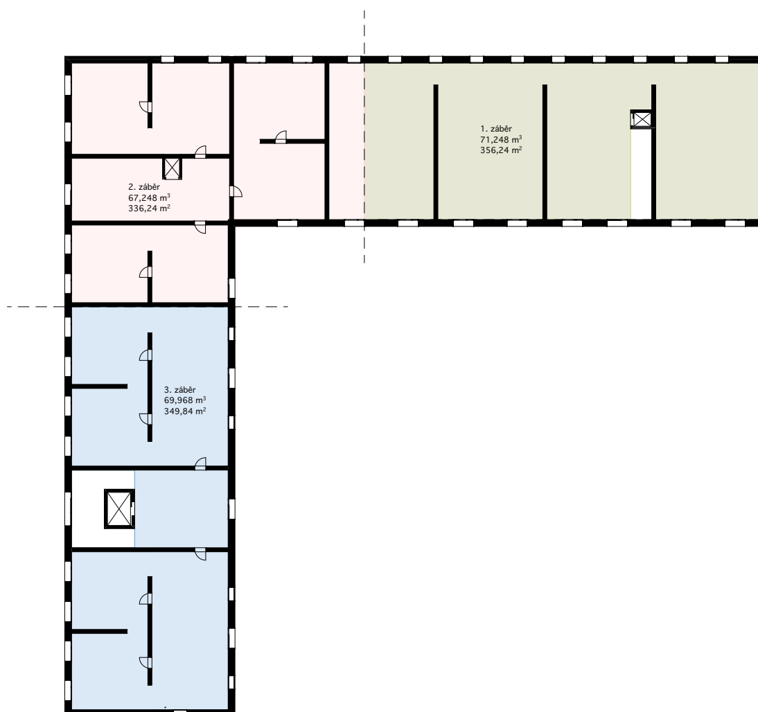
Obrázek č. 8 – Schéma betonářských záběrů vodorovných konstrukcí
